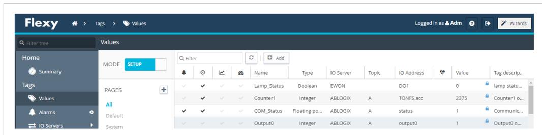
Fig. 5 MODBUS IO server — Tag setup
