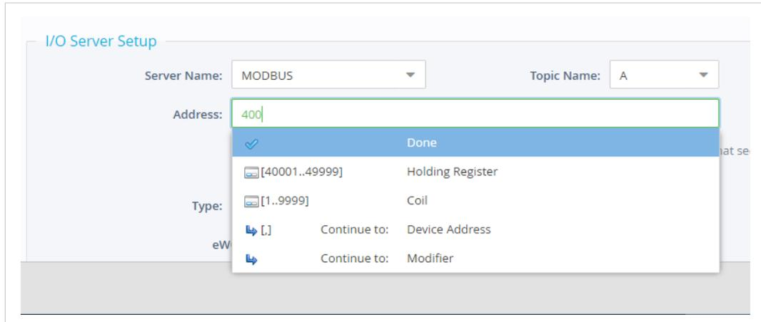
Fig. 7 MODBUS IO server — Tag setup 3
