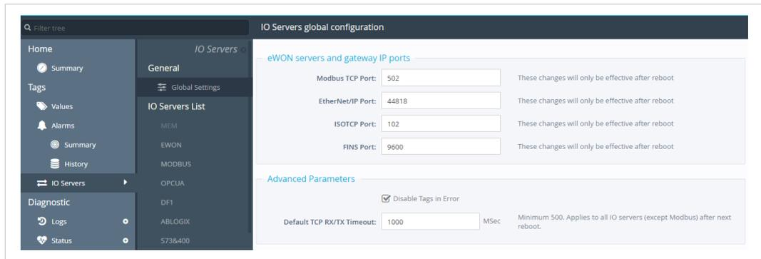
Fig. 14 MODBUS IO server — Disable tags in error
