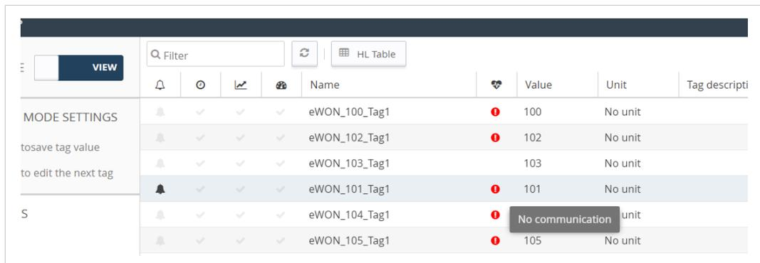
Fig. 12 MODBUS IO server — Tag Error
