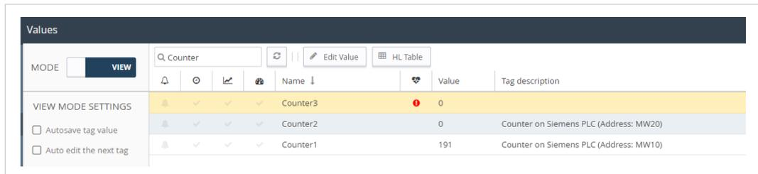
Fig. 11 MODBUS IO server — Tag error
