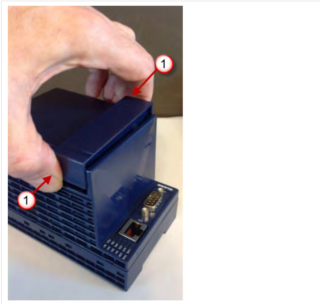
Fig. 9 Remove the slot fillers
